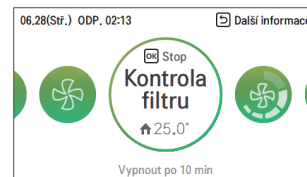
Displej hlavní obrazovky během funkce Automatická kontrola filtru
